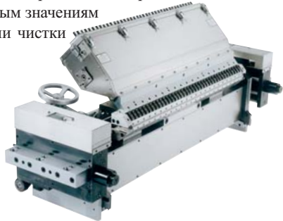
1100 mm головка "Autoflex® VI-R Ultracoat II Die" и поддерживающая система
