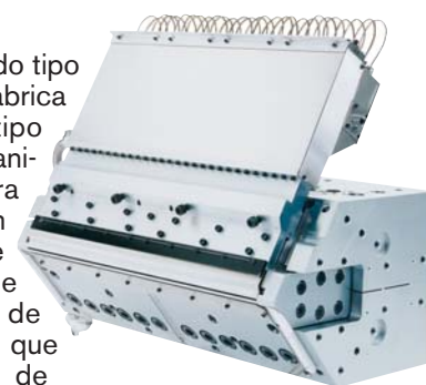
Matriz Multi Manifold (5) automática versão VI-R com 810 mm de largura
